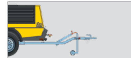
Rudo za vuču bez inercijske kočnice, s parkirnom kočnicom
